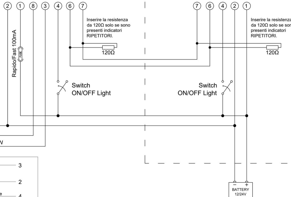
**Pinout Strumento MASTER**
